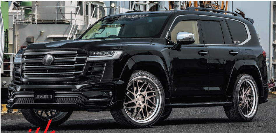
TOYOTA LAND CRUISER (300) COLOR : BLACK CLEAR BRUSHED P.C.D : 6-139.7 PIERCE BOLT : CLASSICAL SIZE : F/R 24100 INSET 17 (L) 295/35-24 ※オーバーフェンダー (30mm) を装着しています。 ●ゴールドクリアブラッシュドと同価格
